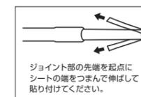
ジョイント部の先端を起点にシートの端をつまんで伸ばして貼り付けてください。
