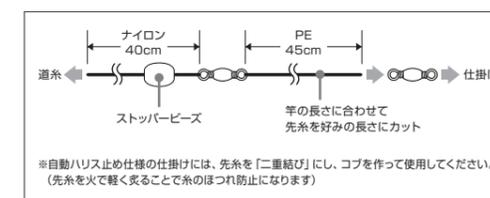
道糸にストッパーピースを通し、先糸を付けることで、仕掛けの巻き込みを防止する便利グッズ。先糸には、糸通しが楽でガイド抜けも良い完全日本産「MAXPOWER PE」を採用しました。さらに、道糸側に上質なナイロン糸を使用することで、自動停止時に発生するPEラインのスプールへのくい込みを最小限に防ぎます。
